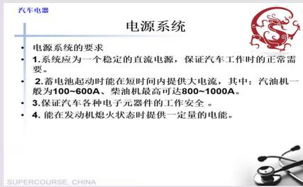
(3) 通过图片介绍汽车的电源系统组成。
